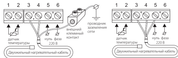
Схема подключения к 3-х проводной электрической сети
